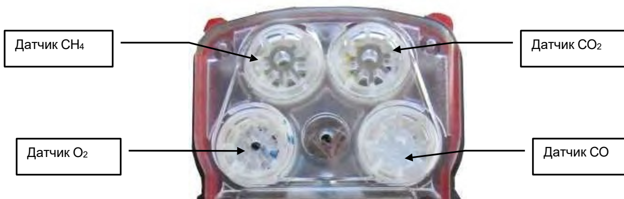
Рис. 3. Схема расположения газопроницаемых входов датчиков
